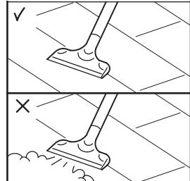
Начинать эксплуатацию SPC пола можно сразу после установки. Уборку SPC пола мы рекомендуем производить с помощью пылесоса, также пол можно убирать влажной или мокрой шваброй. Обратите внимание, что использование пароочистителя запрещено. Для чистки плитки не рекомендуется применять средства, содержащие абразивные вещества, а также средства, содержащие растворители. Такие средства ухудшают внешний вид покрытия и могут привести к его преждевременному износу.
