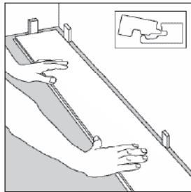
При укладке SPC полов обязательно оставляйте компенсационный зазор между планками и стеной / сопряженными напольными покрытиями и порогами не менее 5 мм.
